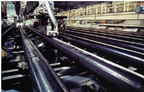
鋼管印字装置
