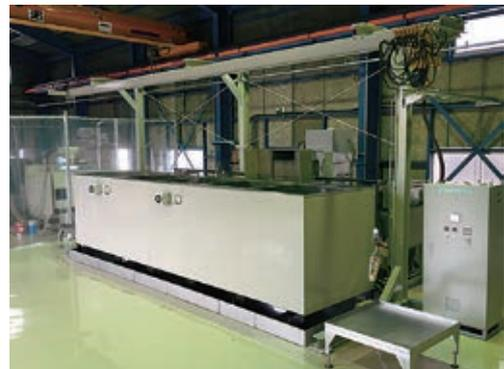
探傷検査前処理装置
