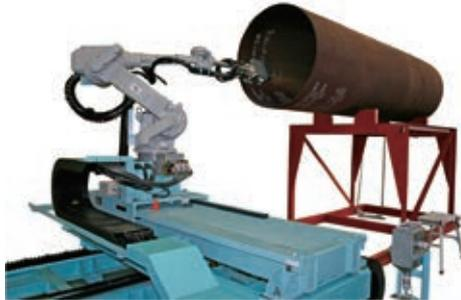
大径管ロボット印字装置
