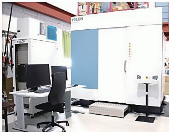
受託検査で使用するX線CT装置
