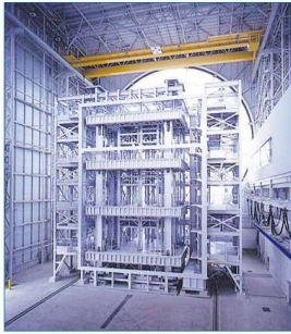
風・環境試験事業で提供するカーデンウォール試験装置(不ニサツ提供)
